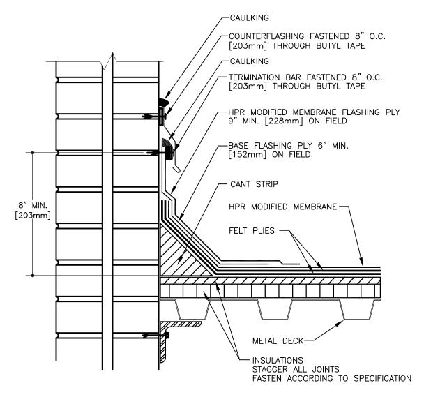
ALL PLIES SET IN BITUMEN SEE SPECIFICATION FOR SURFACING
